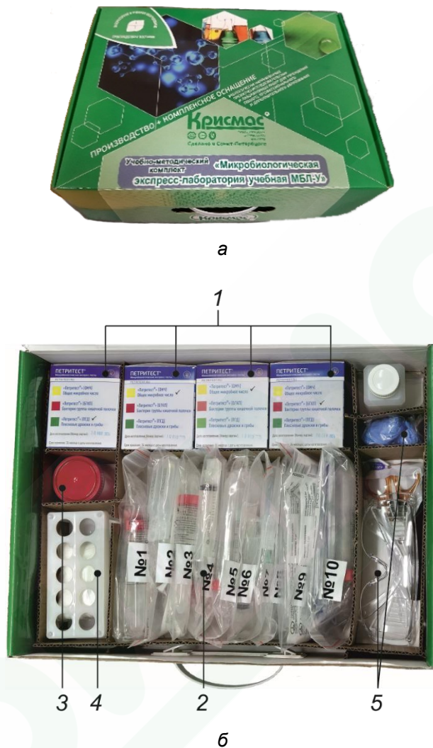
Рис. 3. Микробиологическая экспресс-лаборатория учебная МБЛ-У (а — в укладочной коробке-кейсе, б — общий вид в открытой укладке):
