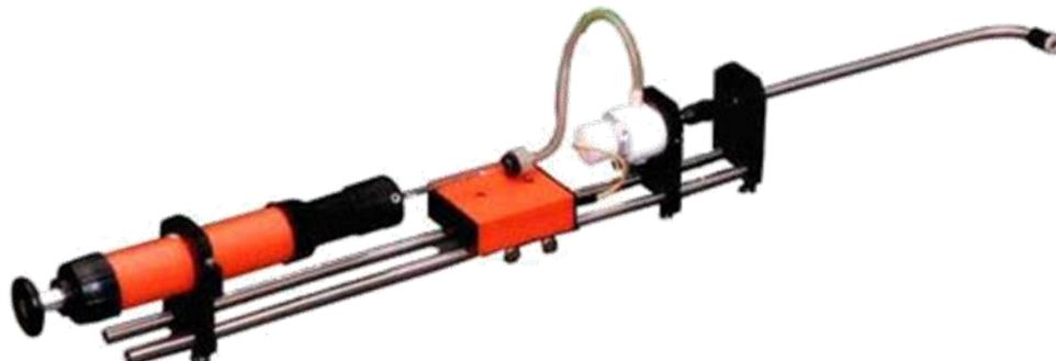
*Рис.1 Зонд пробоотборный ЗП-ГХК-ПВ*
