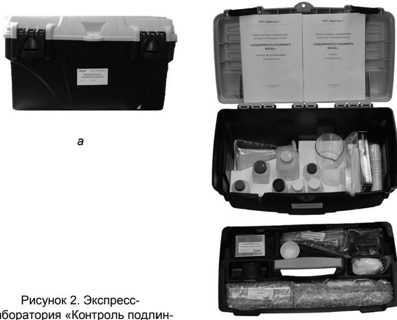
Рисунок 2. Экспресс-лаборатория «Контроль подлинности пчелиного воска» в закрытом (а) и раскрытом (б) виде.
