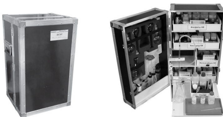
Рис. 2. Общий вид укладки настольной малой секционной ВХЭЛ: а) укладка малая в закрытом виде; б) укладка малая в раскрытом виде;
