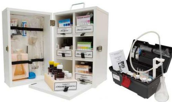
Рис. 3. Судовая водно-химическая лаборатория СЛКВ-1
