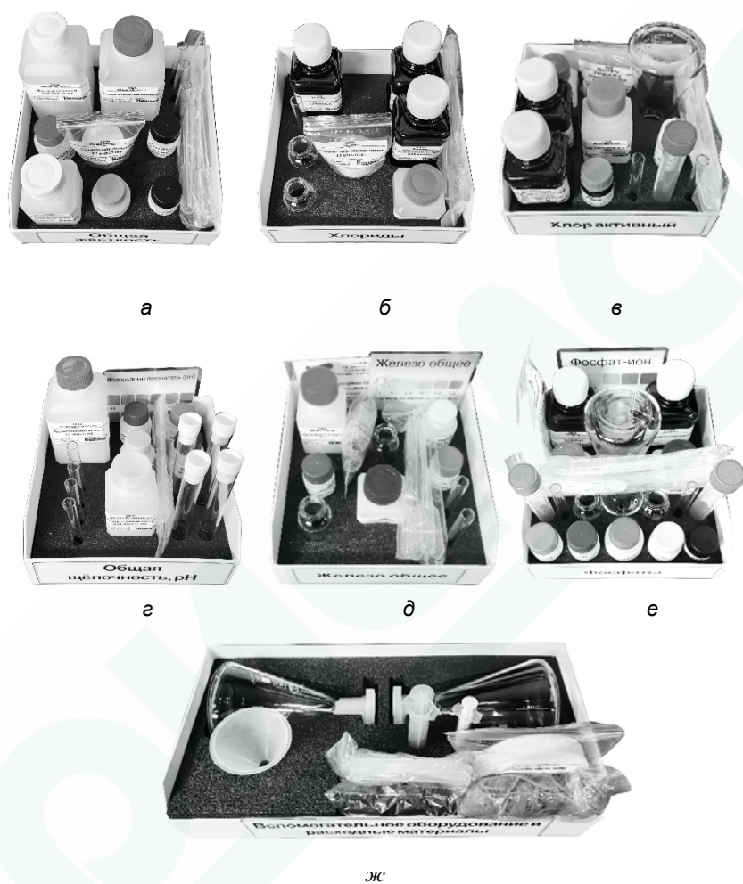
Рис. 3. Укладка настольная секционная СЛКВ. Выдвижные секции: а — «Общая жёсткость»; б — «Хлориды»; в — «Хлор активный остаточный»; г — «Фосфаты»; д — «Щёлочность общая, pH»; е — «Железо общее»; ж — «Вспомогательное оборудование и расходные материалы»
