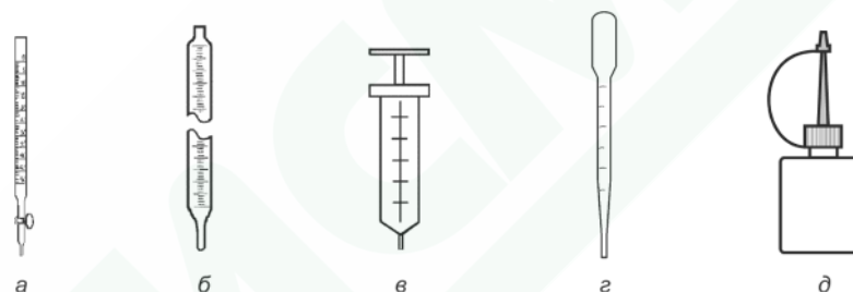
Рис. 10. Средства дозировки растворов: а — бюретка с краном; б — градуированная пипетка; в — шприц-дозатор; г — пипетка полимерная; д — капельница-флакон
