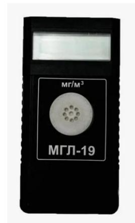
Измеряет массовую концентрацию различных газов в воздухе рабочей зоны
