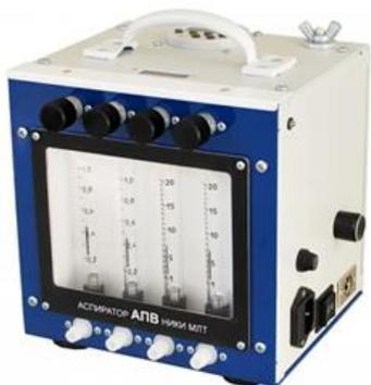
Предназначен для отбора проб воздуха с целью определения содержания в нём загрязняющих примесей (по «пылевым» и «химическим» каналам).
