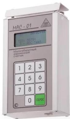
Предназначен для определения концентрации легких положительных и отрицательных аэроионов с целью контроля уровней ионизации воздуха. Применяется на рабочих местах в производственных и общественных помещениях в условиях природной и искусственной аэроионизации.
