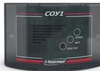
Предназначен для непрерывного контроля концентрации угарного газа в воздухе рабочей зоны. Подает звуковой и световой сигнал. Применяется в котельных, жилых домах, гаражах, на автостоянках, в шахтах, колодцах и невзрывоопасных зонах производственных, административных и общественных помещений.
