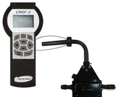
Предназначен для контроля дымности отработавших газов дизельных двигателей.
