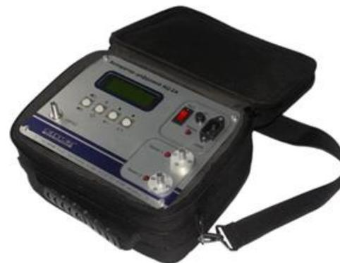
Предназначен для отбора проб атмосферного воздуха и воздуха рабочей зоны с заданным объёмным расходом для последующего анализа. Позволяет проводить разовые и среднесуточные измерения. Прибор зарегистрирован в СИ РФ.
