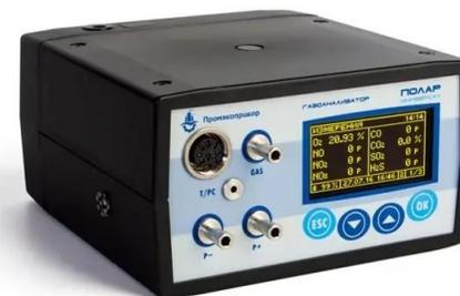
Предназначен для определения содержания загрязняющих веществ в промышленных выбросах топливосжигающих установок. Используется для экологического контроля промышленных выбросов, испытаний котлоагрегатов, оптимизации горения и оценки газоочистного оборудования. Зарегистрирован в СИ РФ.
