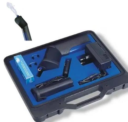
Предназначен для определения направления, скорости и источников движения воздуха с помощью дымовых облаков.
