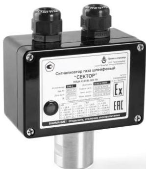
Предназначен для непрерывного автоматического контроля дозврывоопасных концентраций метана, пропана, бутана, пентана или гексана в воздухе рабочей зоны. Применяется на объектах нефтегазового комплекса, энергетики, химической промышленности, АЗС и складах ГСМ. Совместим с системами сигнализации «ЯУЗА-Ex». Зарегистрирован в СИ РФ.
