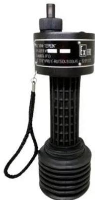
Предназначен для прокачивания через индикаторные трубки заданного объёма исследуемой газовой смеси с целью экспресс-определения концентрации вредных и токсичных веществ в воздухе. Применяется в экологическом аудите, санэпиднадзоре, МЧС, силовых структурах, горнодобывающей и химической промышленности, а также при транспортировке опасных веществ на железнодорожном транспорте. Аспиратор зарегистрирован в СИ РФ.
