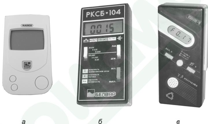
Рис. 2. Бытовые приборы радиационного и дозиметрического контроля:
