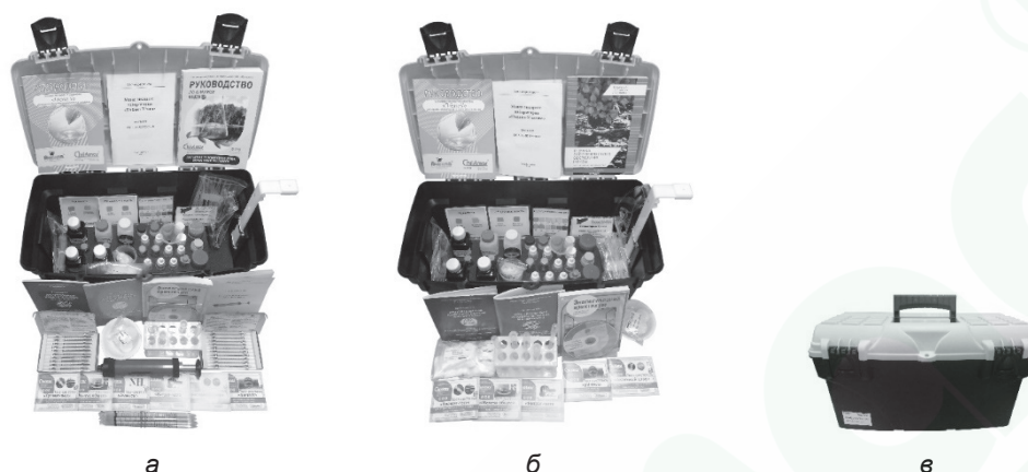
Рис. 3. Мини-экспресс-лаборатории «Пчёлка-У»: а, б — изделия в модификациях «Пчёлка-У/хим» и «Пчёлка-У/почва», в — вид изделий в закрытом контейнере
