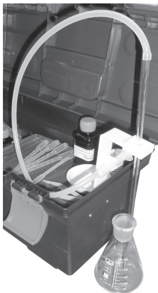
Рис. 4. Принадлежности для количественного гидрохимического анализа из состава мини-лаборатории «Пчёлка-У/хим»
