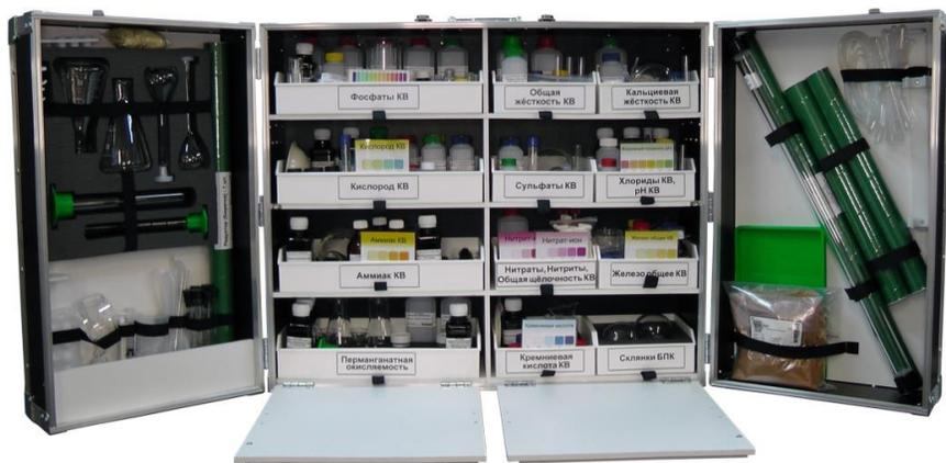
Предназначены для операционного контроля производственных вод и теплоносителей, а также водоподготовки на энергетических объектах.
