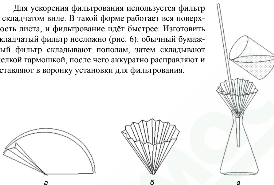
Рисунок 6. Приготовление складчатого фильтра и фильтрование: а — изготовление складчатого фильтра, б — готовый складчатый фильтр, в — установка для фильтрования
