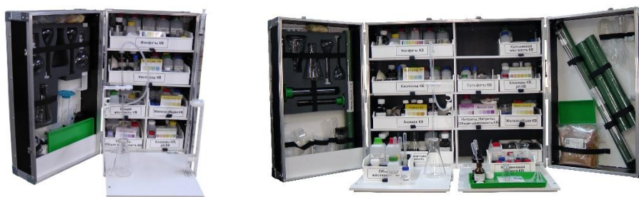
Рис. 2 Водно-химические экспресс-лаборатории котловые модели ВХЭЛ-1 и ВХЭЛ-2
