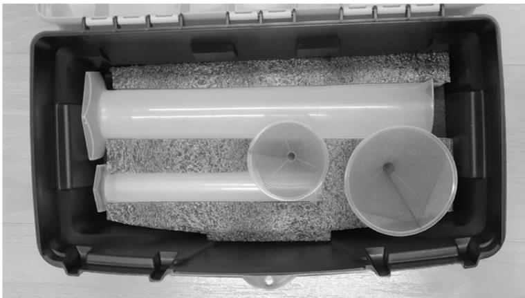
Рисунок 1. Набор для измерения атмосферных осадков «Осадкомер» в укладочном контейнере
