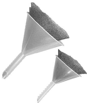
Рисунок 3. Воронки с сетчатыми фильтрами
