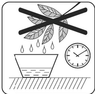
3.2.1. Установите чистый пустой пробоотборник для сбора осадков (либо собранную установку) на горизонтальной поверхности в выбранном месте проведения сбора осадков.
