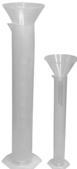
Рисунок 2. Установки для измерения объёма осадков на основе градуированных цилиндров на 100 мл и на 500 мл с воронками
