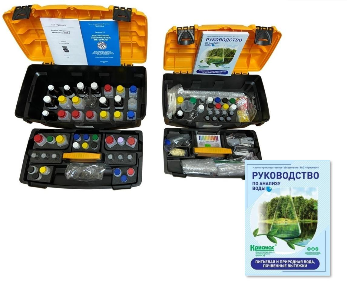
Наиболее компактная модель, легко переносимая и разворачиваемая. Применима **для анализа питьевой и природной воды** по важнейшим (от 14 и более) показателям, возможно применение при анализе **в процессах водоподготовки**.
