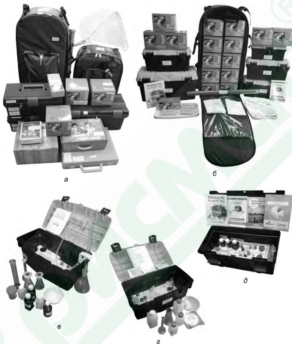
Рис. 5. Некоторые модульные изделия и портативные лаборатории на основе унифицированных методов анализа: а — многофункциональная лаборатория «Я эколог»; б — укладка-лаборатория полевого химического контроля качества воды войсковая УКВ; в — портативная лаборатория «Остаточный активный хлор»; г — портативная лаборатория для определения фосфора в воде в разных формах «Фосфор»; д — мини-экспресс-лаборатория «Пчёлка-У/хим»
