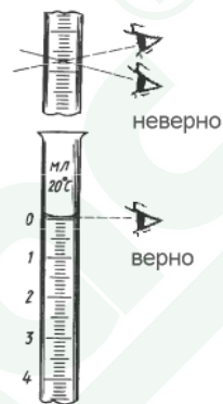
Рисунок 10. Наблюдение уровня жидкости (мениска) при титровании.
