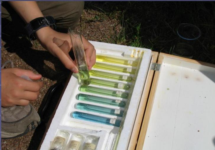
Измерение гидрохимических показателей с помощью ранцевой полевой лаборатории «НКВ-Р» производства ЗАО «Крисмас+»:
