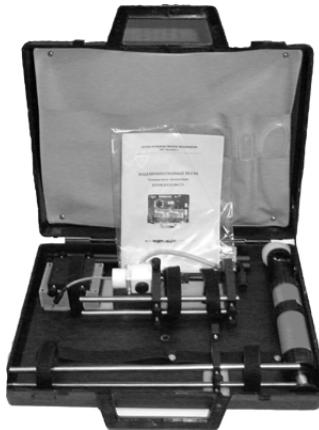
Рис. 7. Внешний вид зонда пробоотборного 3П-ГХК в укладке типа «мини-кейс»
